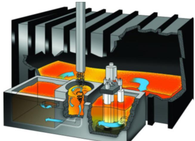
Dicho proceso mejoró aún más con el uso de 1 por ciento de fundente Coveral 18S con la alimentación de la chatarra. Resultando en una tasa de recuperación muy alta y una mejora del rendimiento del 3 por ciento en comparación con el método manual convencional.
